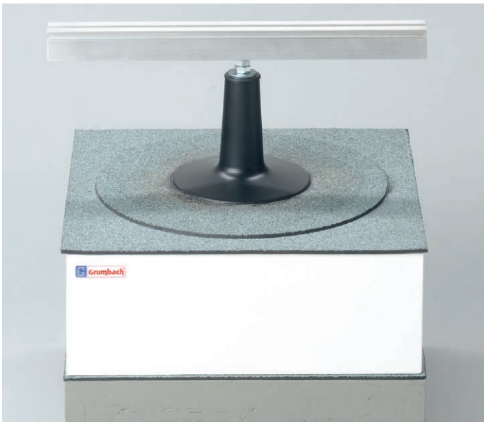
Befestigungsdurchführung aus PUR (schwarz) wärmeisoliert, FCKW-frei, mit integrierter Gummidichtung und eingeschäumter Anschlussbahn (Bitumen, PVC oder Sonderfolie).
